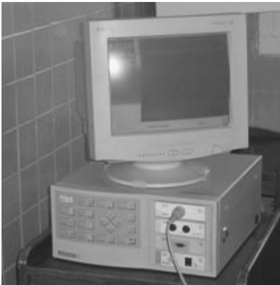
Fig. 9.9. Equipo electrónico para medir la tensión arterial con lectura digital.
